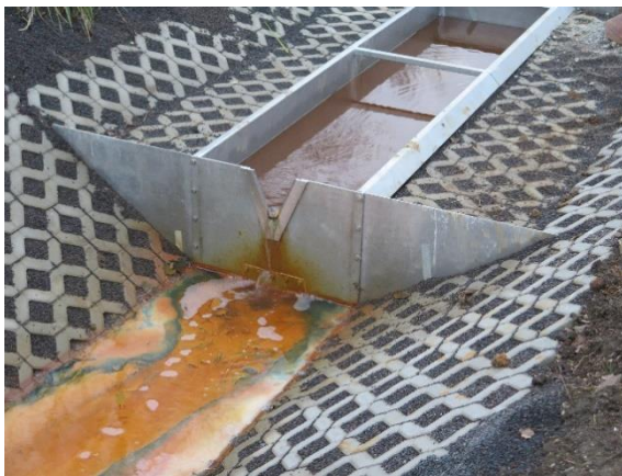
Messwehr Edelstahl mit Wehrtafel V-Ausschnitt
