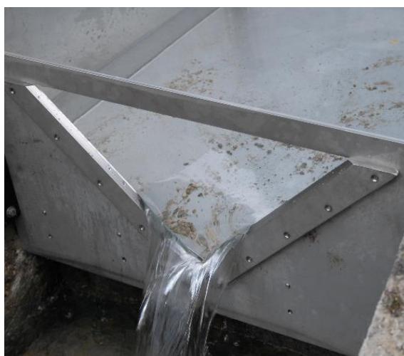
Messwehr Edelstahl mit Wehrtafel V-Ausschnitt
